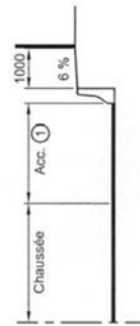
C. SECTION TYPE URBAINE AVEC GLISSIÈRE RIGIDE LATÉRALE
